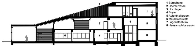
Querschnitt im Bereich Foyer, M 1:500
