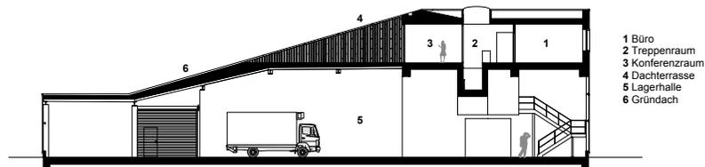
Querschnitt im Lagerbereich, M 1:500
