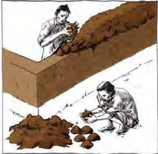
DIE MISCHUNG WIRD VON HAND ZU LEHMKLUMPEN GEFORMT UND ANSCHLIEßEND EINZELN, IN EIMERN, ODER IN KÖRBEN ZUR WAND GETRAGEN.
