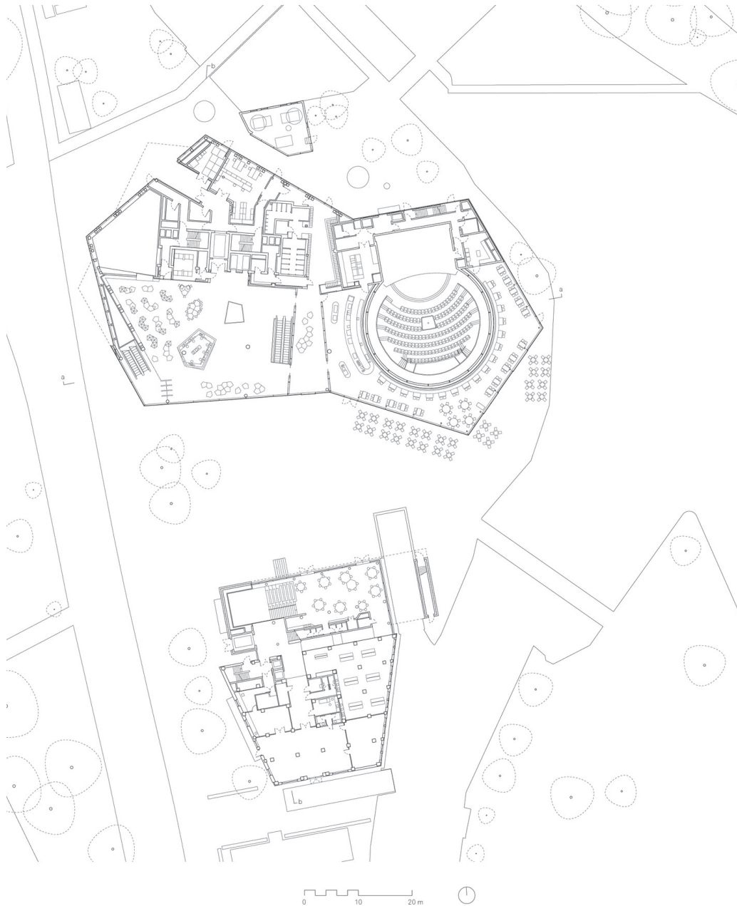
Grundriss EG mit Nachbargebäude, 1:1000
